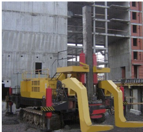
Рис. 8.13. Сваевдавливающая установка СУПС-В, выпускаемая ОАО «Пролетарский завод»
